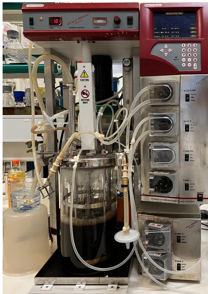
Figura 6 – Biorreator da Electrolab Biotec, modelo FerMac 360, utilizado nos ensaios.
