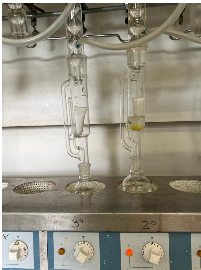
Figura 8 – Montagem experimental da extração Soxhlet.
