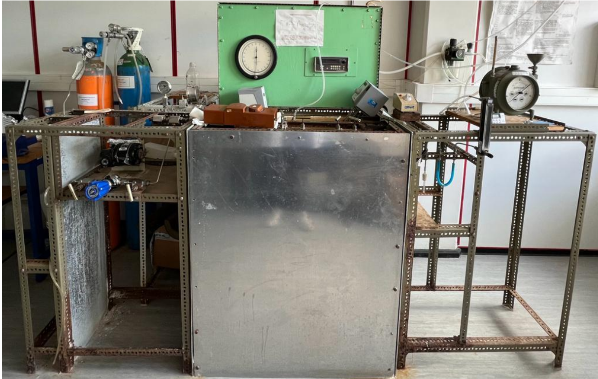
Figura 10 – Equipamento de extração supercrítica utilizado na atividade experimental.
